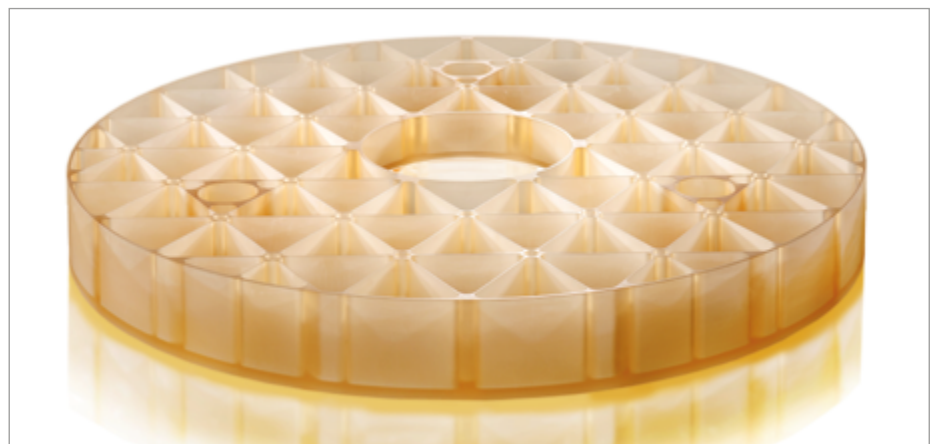
Los sustratos de espejo ZERODUR® para telescopios espaciales se vuelven más ligeros mediante un rectificado de precisión para eliminar hasta el 90 % de la fundición original sin que pierdan la resistencia necesaria para sobrevivir al lanzamiento y a las duras condiciones del espacio exterior. (Imagen: SCHOTT)
