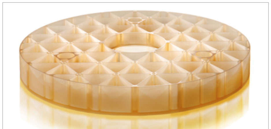
用于空间光学的ZERODUR®镜基板通过精密磨削进行轻量化处理,最多可去除90%的原始铸件材料,同时保留发射过程及恶劣太空环境所需的结构强度。(图片来源: SCHOTT)
